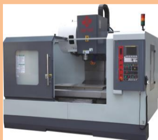
Hình 1. Máy phay CNC
